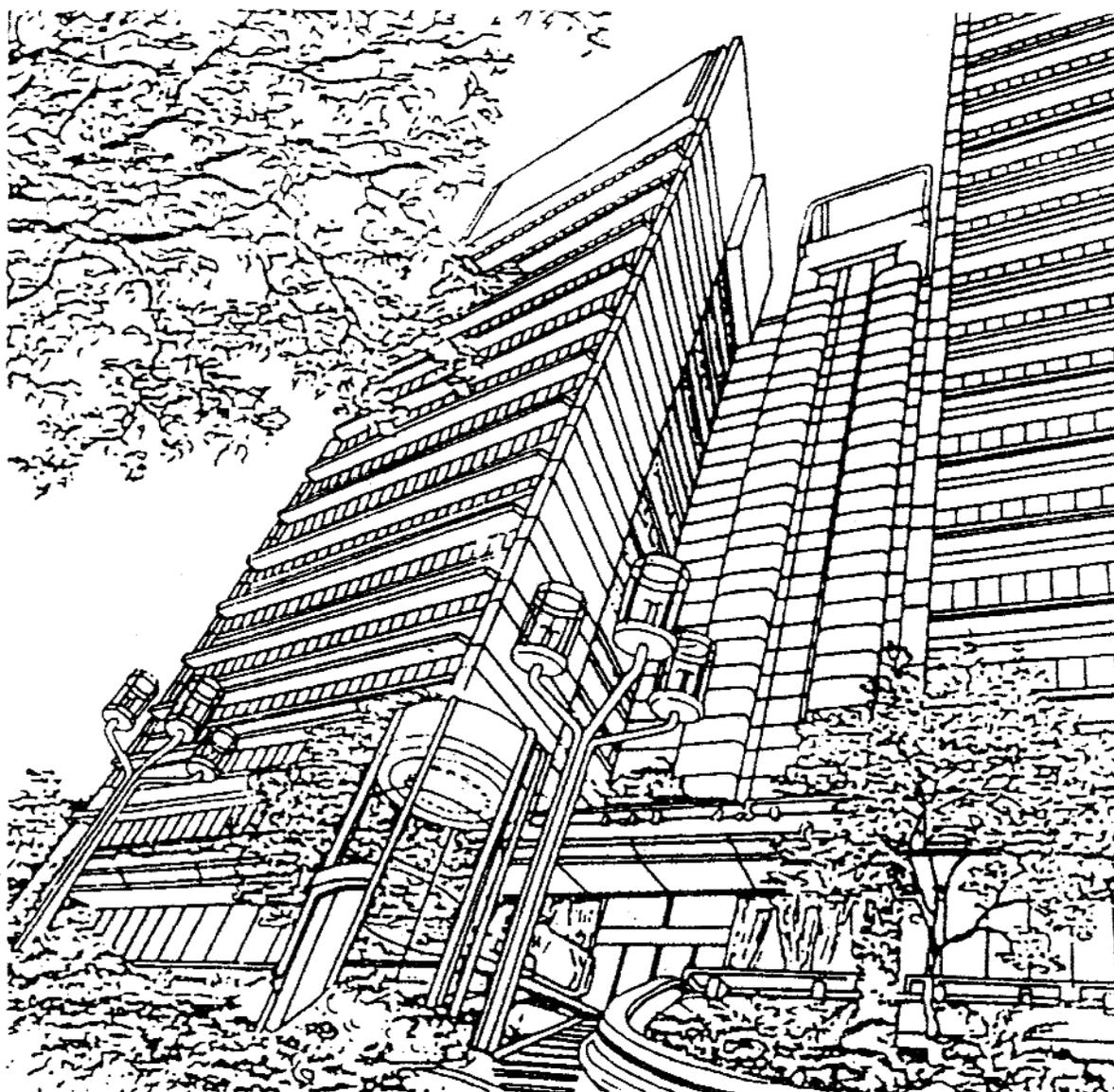
Figura A 5 - Imagen de espacio exterior, proyección con plano inclinado de proyección y tres puntos de fuga de acuerdo al método descrito en 6.5.1.
