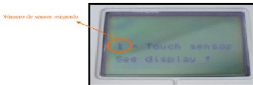
Este mensaje muestra en qué puerto debe conectarse el sensor de tacto para hacer la prueba. Conectar el sensor mediante un cable de datos como muestra en la figura siguiente. Al presionar el sensor se desplegará el resultado en pantalla.
