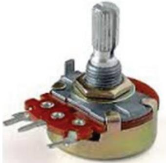
Un potenciómetro es un resistor cuyo valor de resistencia es variable. De esta manera, indirectamente, se puede controlar la intensidad de corriente que fluye por un circuito si se conecta en paralelo, o la diferencia de potencial al conectarlo en serie.
