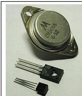
El tamaño de un transistor guarda relación con la potencia que es capaz de manejar.
